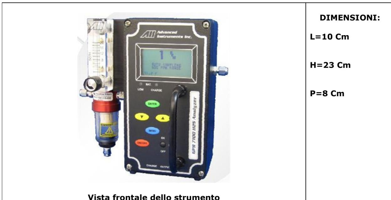
L'analizzatore portatile di H<sub>2</sub>S GPR-7100 e' l'ideale per impieghi negli impianti di gas naturale dove e' necessario effettuare misure a campione precise, veloci ed affidabili. Lo strumento e' in grado di misurare concentrazioni di acido solfidrico in flussi gassosi in soli 35 secondi. Lo strumento include un flussimetro ed un filtro a coalescenza. La durata della cella e' di 24 mesi (a 25°C e 1 Atm).
