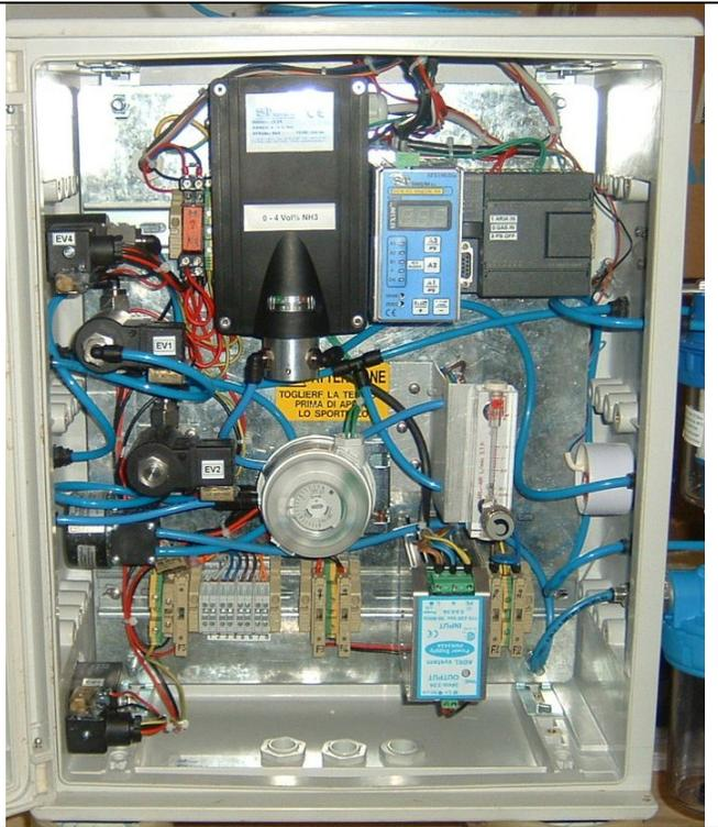
**SISTEMA DI AUTOMAZIONE REALIZZATO CON PLC SIMATIC E PANNELLO OPERATORE OP 73**
